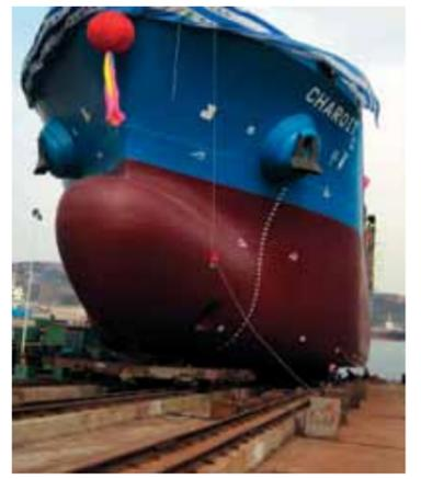
лом морях. Обводы, ледопродолимость и прочность корпуса, мощность главного двигателя полностью соответствуют новым требованиям Финско-Шведских ледовых правил.
