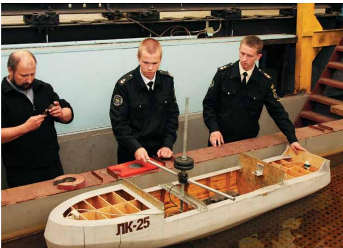
Буксировка моделей осуществляется с помощью буксировочной тележки. Электродвигатель, обеспечивающий движение, установлен на ее борту. Для измерения сопротивления воды движению модели используется динамометр индуктивного типа, пружины которого обеспечивают измерение сил в 3 различных диапазонах нагрузок от 5 н до 500 н.
