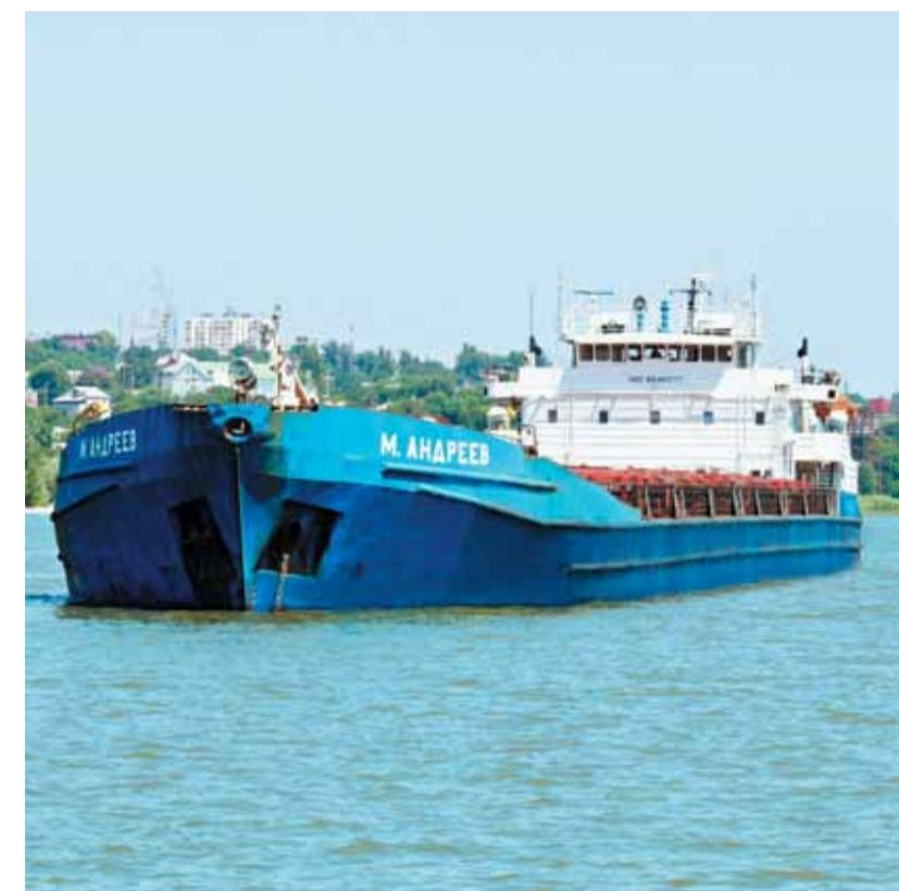
Теплоход «Михаил Андреев» (судовладелец — ОАО «Донречфлот») предназначен для перевозки генерального груза. Порт приписки — Таганрог. Длина судна составляет 138,3 м, ширина — 16,7 м, высота борта — 5,5 м. Валовая вместимость судна составляет 3969 т. Дедвейт судна — 4038 т. Судно перевозит зерновые грузы по маршруту «Багаевская — Кавказ».
