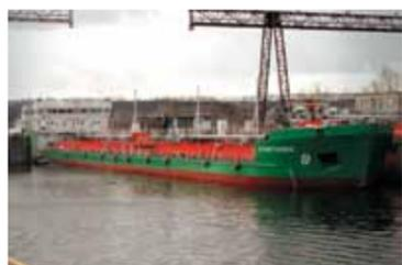
Танкеры проекта RST25, разработанного Морским инженерным бюро, представляют собой самоходные наливные суда смешанного «река-море» плавания с 6 грузовыми танками, предназначенные для перевозки сырой нефти и нефтепродуктов, в том
