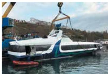
Морское пассажирское судно на подводных крыльях «Комета 120М», построенное на рыбинском судостроительном заводе «Вымпел», прибыло на достройку в Севастополь. Судно было перегружено с баржи на воду, затем краном — на причальную стенку завода «Персей».
