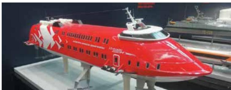
**Д**вухъярусное судно «Циклон 250М» предназначено для перевозки до 300 пассажиров на расстояние до 700 морских миль. Длина судна составляет 46 м, полное водоизмещение — 220 тонн. В качестве главной энергоустановки в базовой комплектации предусмотрены двигатели MTU мощностью 2x2560 кВт.
