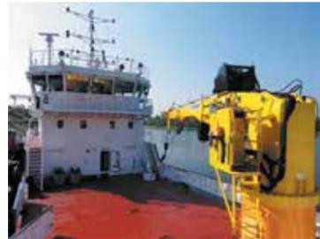
по КВЛ — 9,70 м; высота борта на миделе — 3,50 м; осадка (по КВЛ/максимальная) — 2,0/2,5 м; скорость — 11,8 узл.; автономность — 15 суток. Класс РРР: М-СП 3.5 (лед 40) А.
