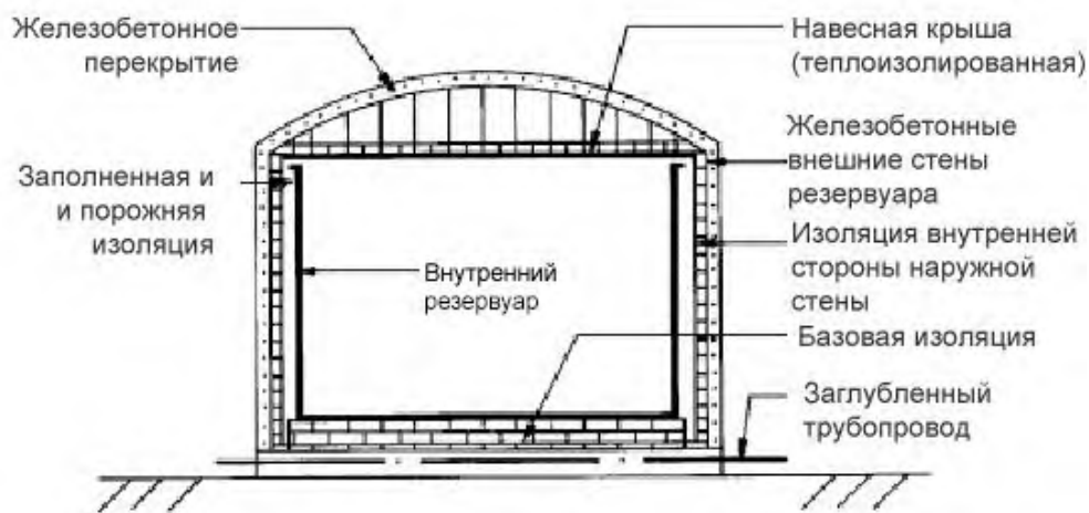
Рисунок 11 – Резервуар с полной защитной оболочкой
