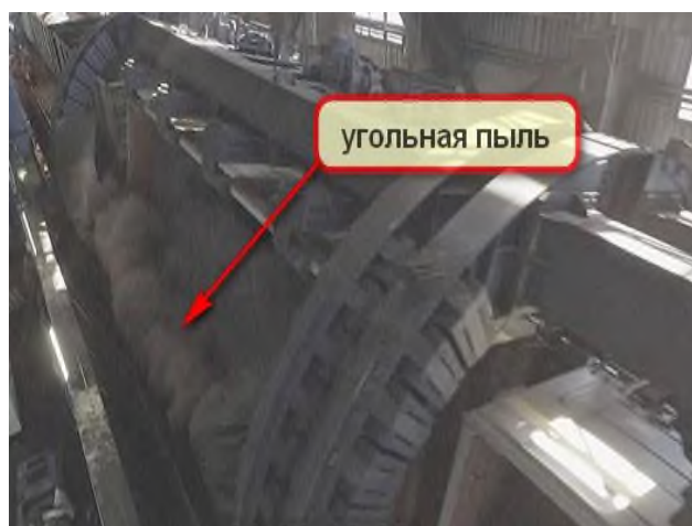
Рисунок 49 – Оборудование СРВ – организованный источник пыления
