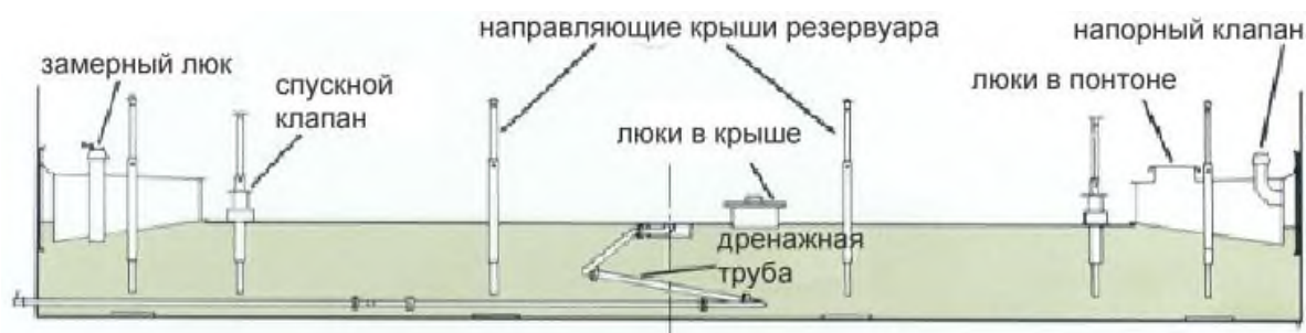
Рисунок 2 – Пример типичной плавающей понтонной крыши
