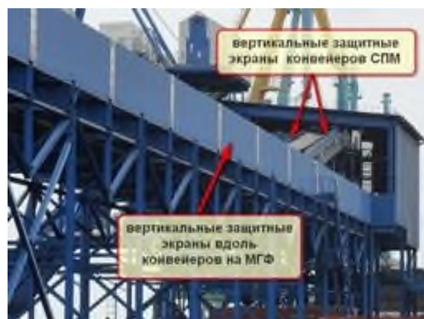
Рисунок 89 – Вертикальные защитные стенки
