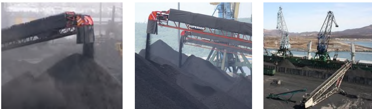
Рисунок 70 –Источники пыления в конвейерных транспортных системах
