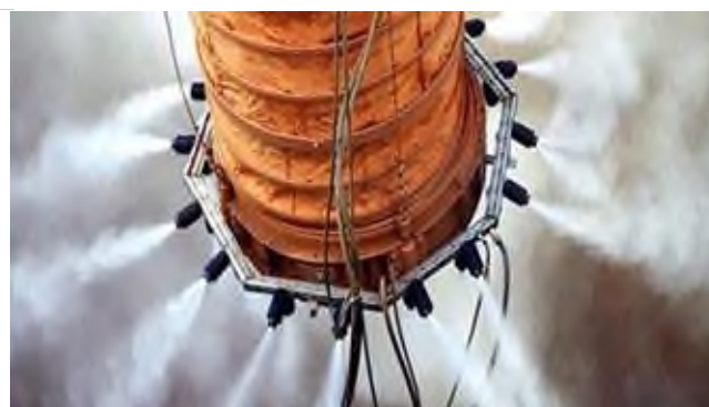
Рисунок 61 – СПМ на МГФ с системой пылеподавления и орошения – организованный точечный источник пыления
