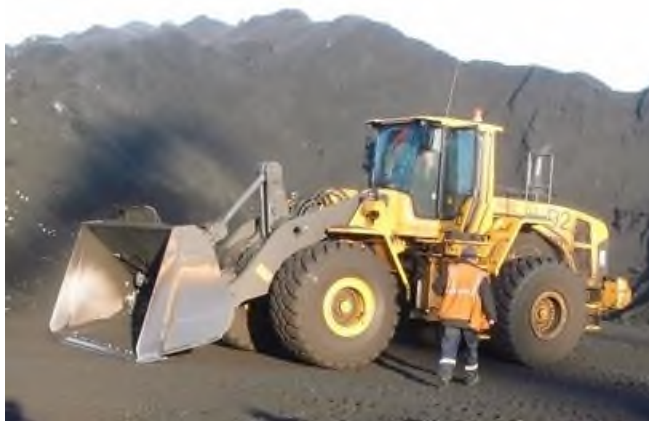
Рисунок 63 – Ковшевой автопогрузчик для штивки угля
