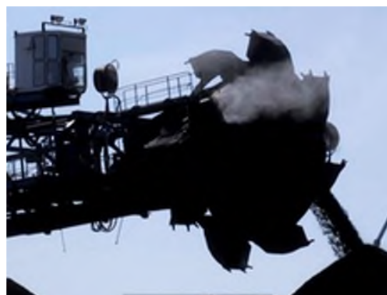
Рисунок 78 – Пылеподавление на рабочих органах стакеров и реклаймерах
