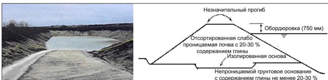
Рисунок 14 – Пример организации пруда-отстойника
