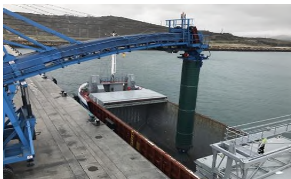
Рисунок 61 – СПМ на МГФ с системой пылеподавления и орошения – организованный точечный источник пыления
