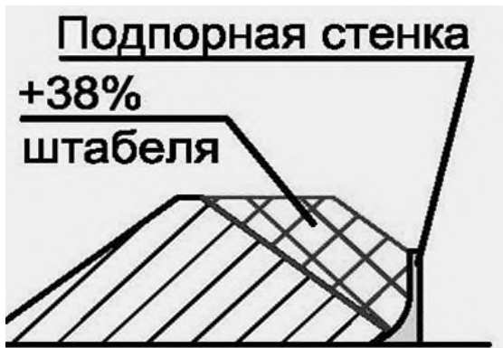
Рисунок 90 – Подпорные стенки для штабелей угля на складе
