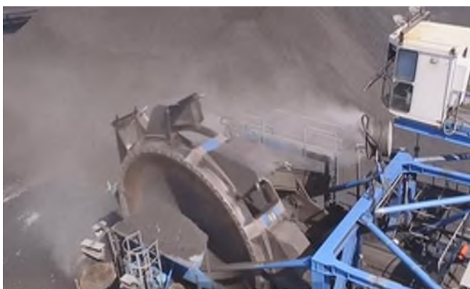
Рисунок 78 – Пылеподавление на рабочих органах стакеров и реклаймерах
