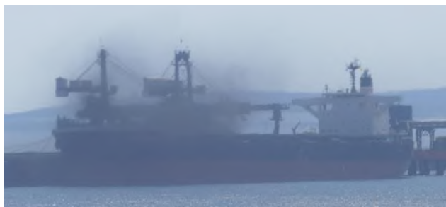
Рисунок 60 – СПМ на МГФ – неорганизованный источник пыления
