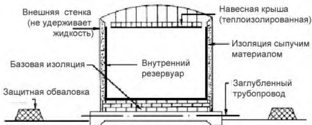
Рисунок 9 – Резервуар с одинарной стенкой
