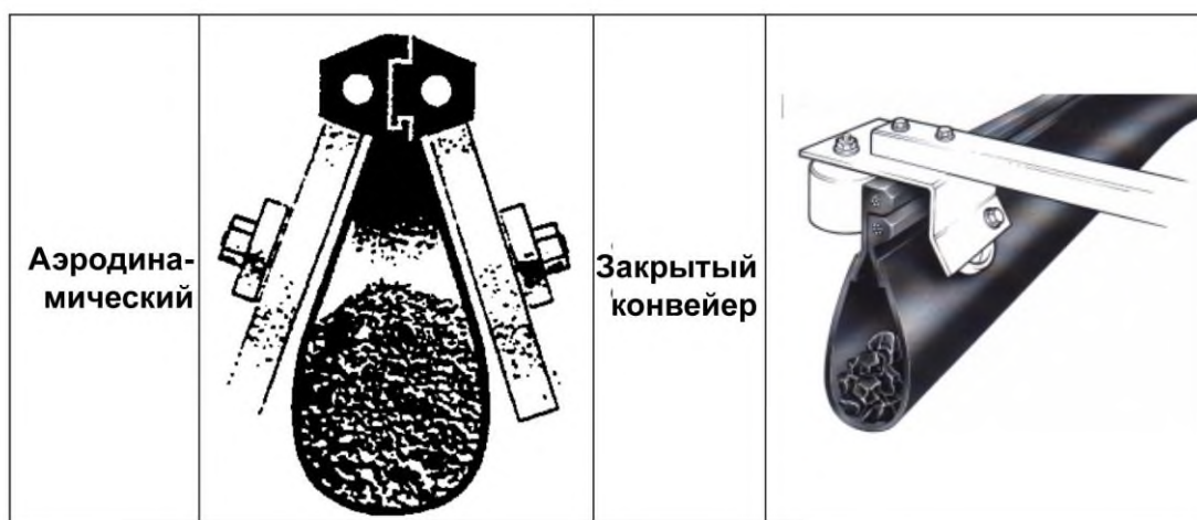
Рисунок 31 – Примеры подвесных ленточных конвейеров
